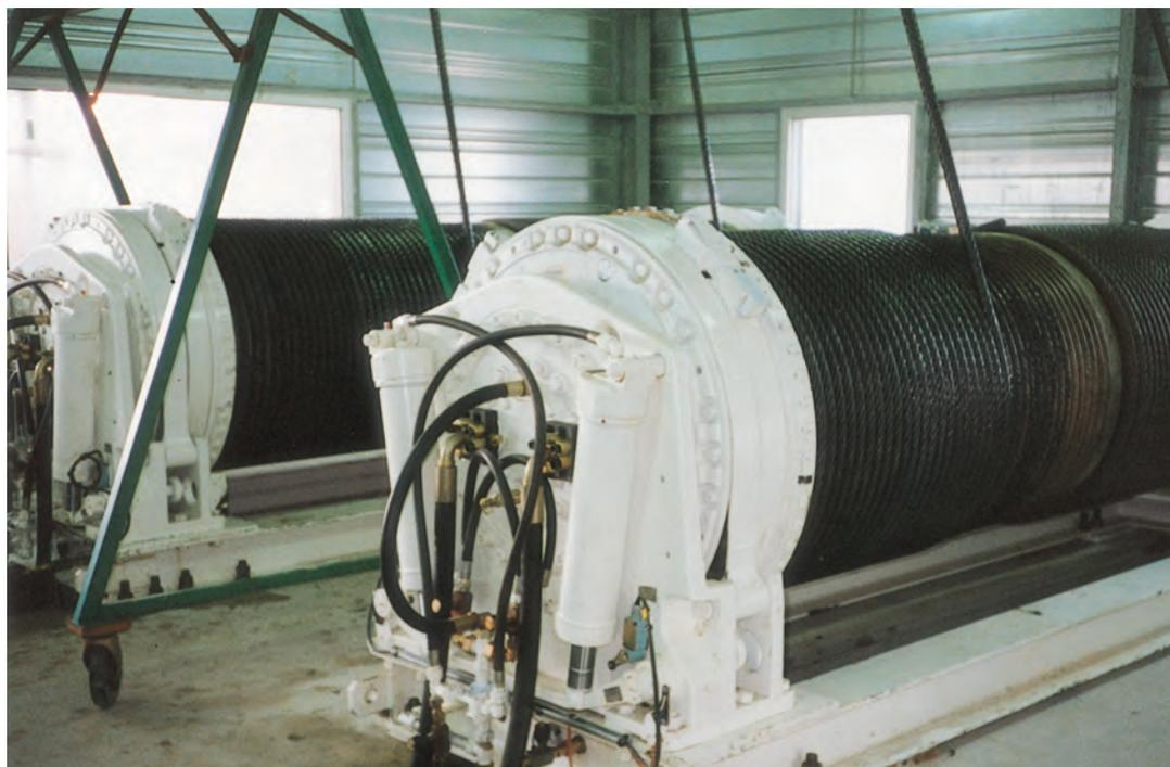
Гидромоторы серии Hägglunds VI первыми сошли с конвейера Hägglunds. Изначально они были разработаны с целью увеличения эффективности, надежности и управляемости судовых приводов. Однако благодаря этим характеристикам они нашли применение и в других отраслях, в частности, в целлюлозно-бумажной и горнодобывающей промышленности.
