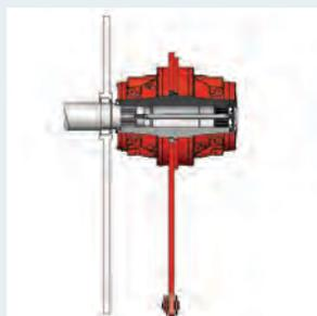
▲ Гидромотор, монтируемый с моментным рычагом, со шлицами
